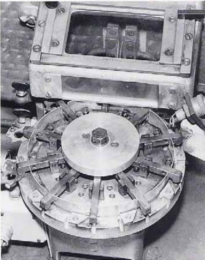
Bild 21: Rundschalttisch für das HF-Induktionslötens
