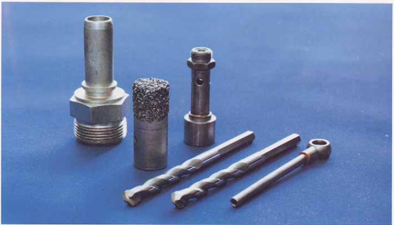
Bild 17: Im Schutzgas HF-induktionsgelötete Rohrtülle, beschichteter Rauhkörper, Brennerdüse, Bohrer mit eingelöteten Hartmetallplättchen, Rohrverbinder
