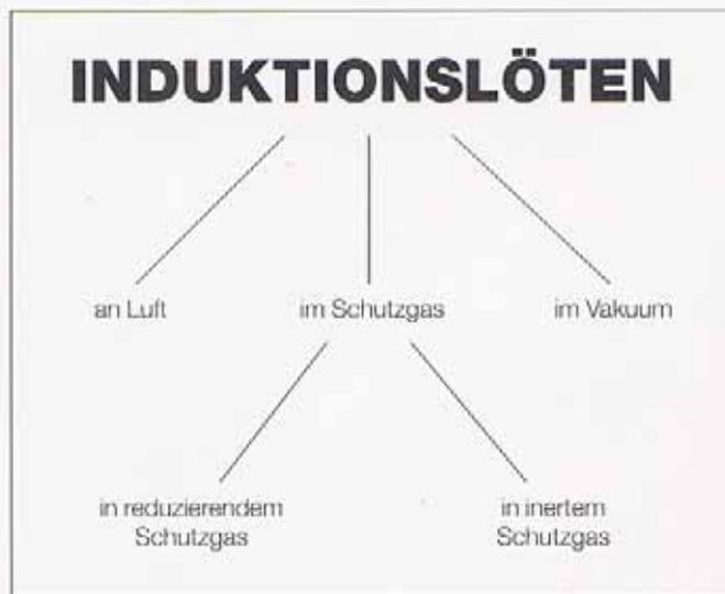
Bild 4: Induktions-Lötverfahren
