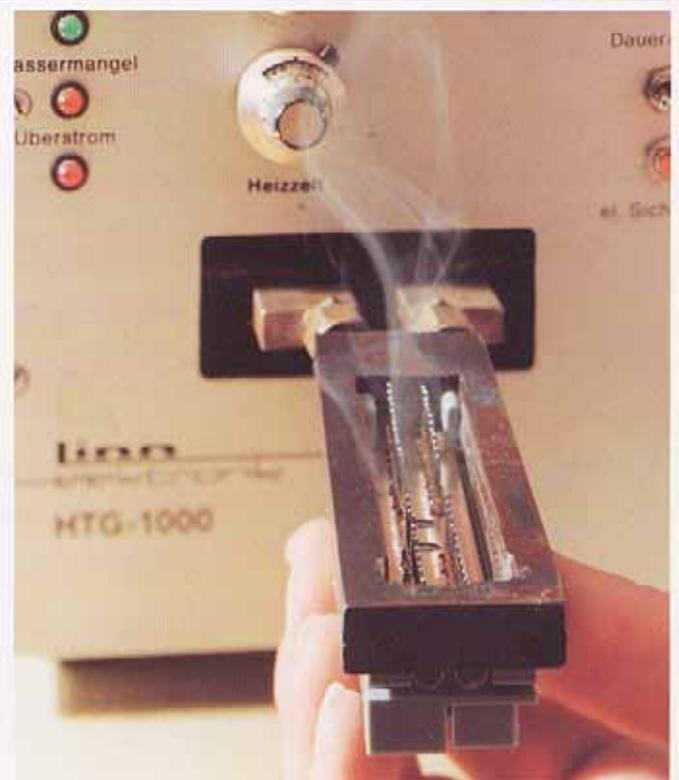
Bild 19: Gleichzeitiges Weichlöten von 24 Lötverbindungen bei der Fertigung von Connektoren
