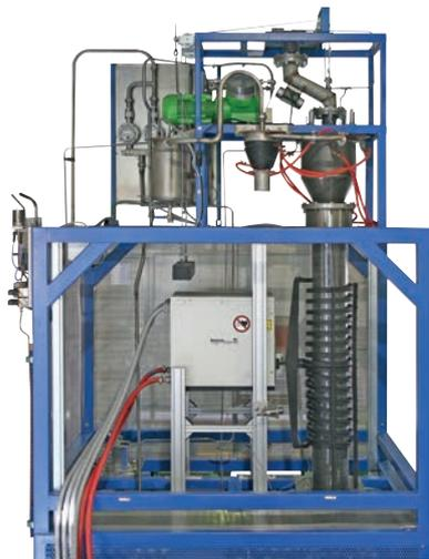
Induktiv beheizter Wirbelschicht- und Festbettreaktor, gasdicht, Graphitfilz-Isolation.
