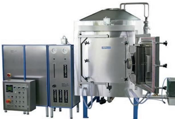
Kammerofen ASW-Isolation, gasdichte Muffel, Reinraum.
