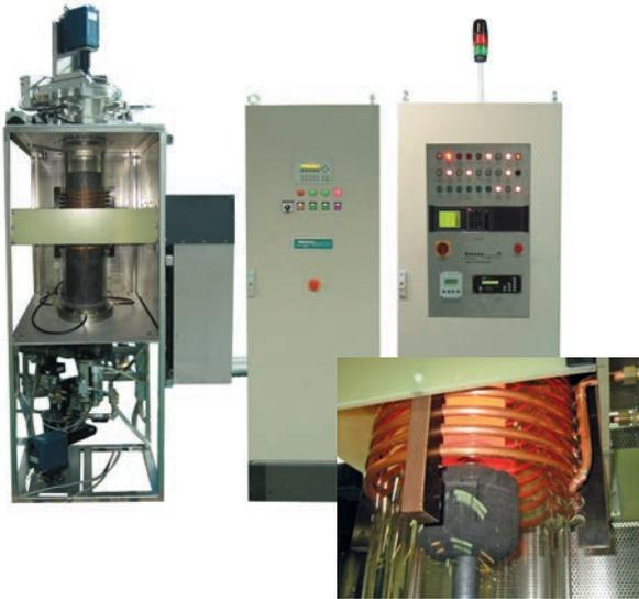
Induktiv beheizter Kristallzuchtreaktor, gas- und vakuumdicht, Graphitfilz-Isolation.
