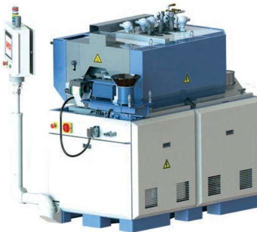
Bandofen mit schutzgasdichter Muffel und Abschreckeinrichtung, ASW-Isolation.
