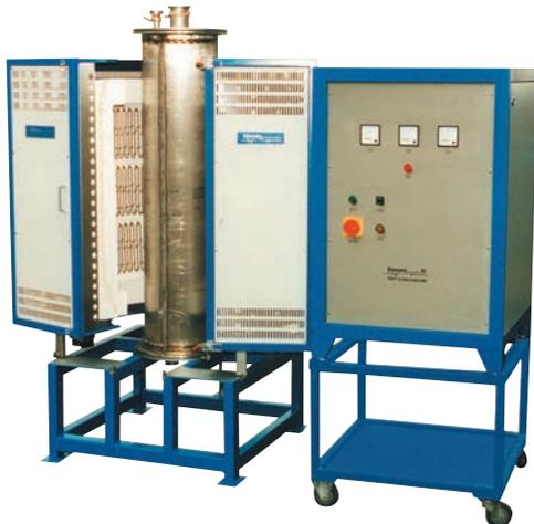
3-zoniger aufklappbarer Reaktorheizer, ASW-Isolation, gas- und vakuumdicht.
