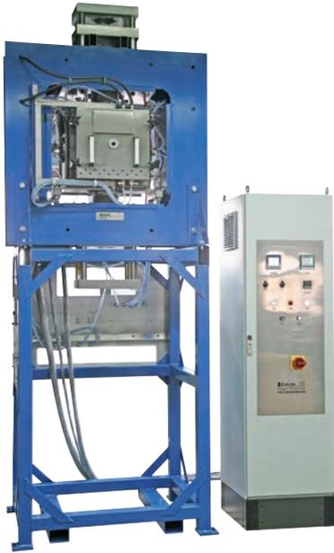
Kammerofen, Hochtemperatur, PCW- und Graphit-Isolation, gasdicht, 20 l.
