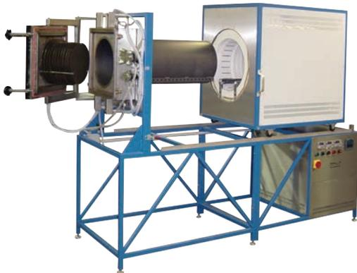
3-zoniger verfahrbarer Hochvakuum - Rohrofen, ASW-Isolation, gas- und vakuumdicht.
