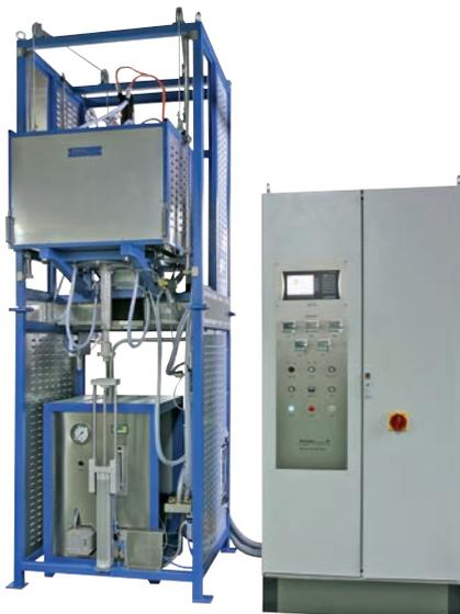
Verfahrbarer Rohrofen, mehrzonig, gasdicht mit Schnellabschreckung in Flüssigmetall, Graphitfilz-Isolation.
