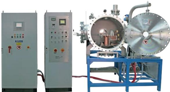
Induktiv beheizte Mittelfrequenz-Kaltwand- und Schwebeschmelz-Anlage, gas- und vakuumdicht, P<sub>max</sub> 10 bar.
