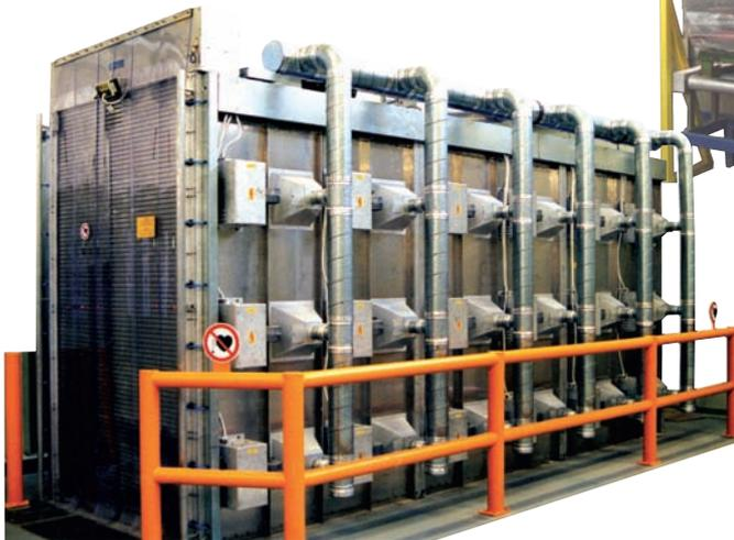
Mikrowellen-Kammertrockner mit Rollenbahn
