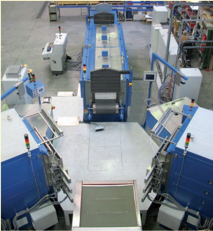
Automatische Gießlinie für Titan- und TiAl-Bauteile Automatical casting line for Titanium- and TiAl components
