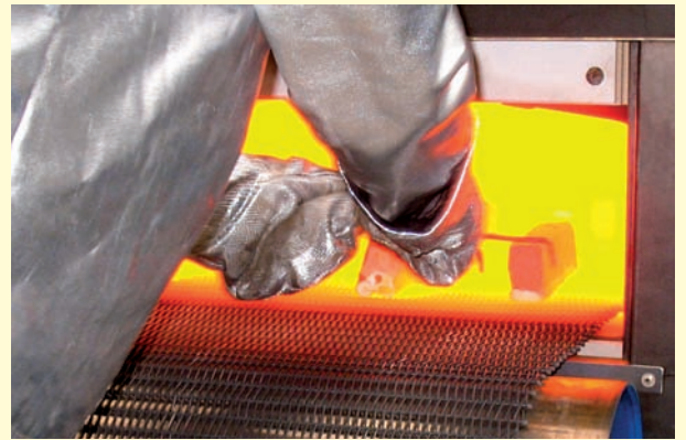
Einlegen einer gegossenen Gießform in einen Wärmebehandlungs-Banddurchlaufofen Insertion of a casted mould into a heat treat continuous belt furnace
