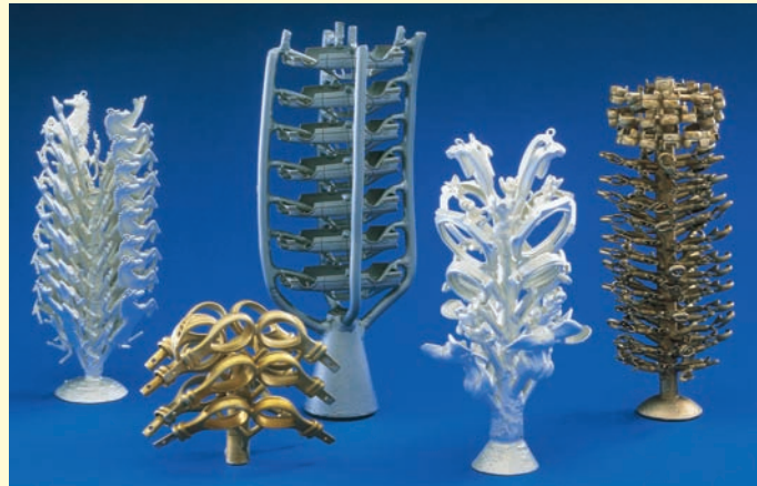
Gussbäume aus Gold, Silber und Titan Casting trees of gold, silver and titanium
