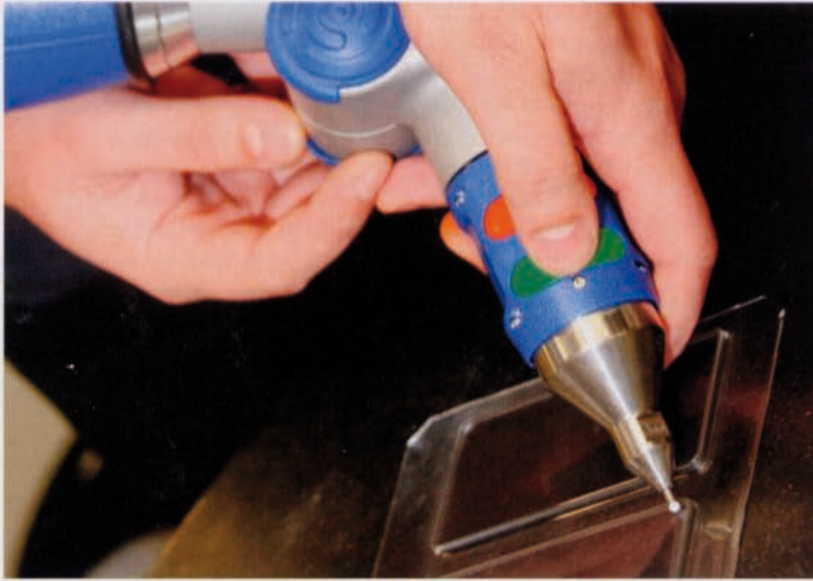
Mit einem Präzisionsgerät werden die Konturen von Bauteilen genau vermessen und kontrolliert.
