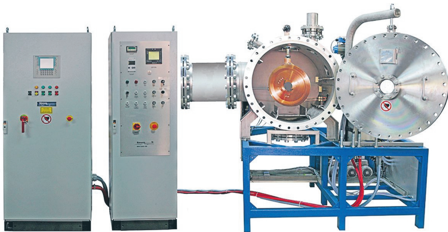
Eines der vielen Nischenprodukte, das in Eschenfelden entwickelt und produziert wird, ist die induktiv beheizte Meltsplanlage zur Herstellung von metallischen Gläsern.
