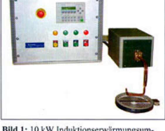
Bild 1: 10 kW Induktionserwärmungsumrichter Fig. 1: 10 kW induction heating converter
