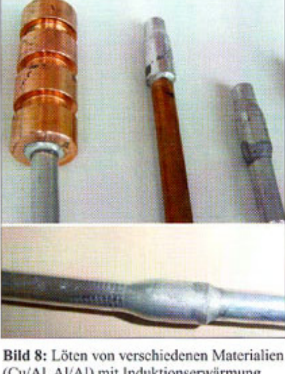
Bild 8: Löten von verschiedenen Materialien (Cu/Al, Al/Al) mit Induktionserwärmung Fig. 8: Brazing with different materials (Cu/Al), Al/Al) by induction heating
