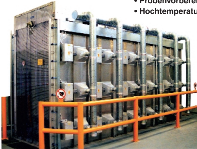
Mikrowellenkammeröfen, MKT, bis 100 kW, 30 m 3 Microwave chamber dryer, MKT, up to 100 kW, 30 m 3
