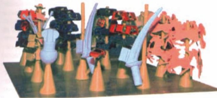
Рис. 6. Выплавляемые модели, собранные в модельные блоки
