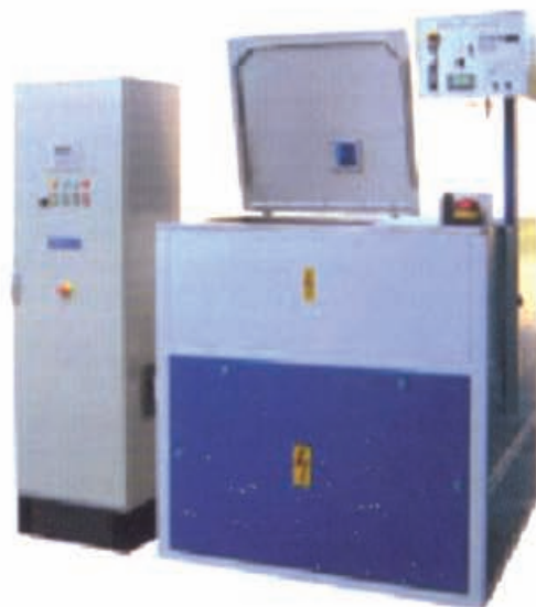
Рис. 2. Установка центробежного литья Supercast со среднечастотной индукционной плавильной установкой
