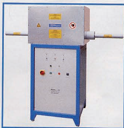
Bild 1. Mikrowellen-Durchlauferhitzer zum Aushärten und Verkleben von Fasern.
