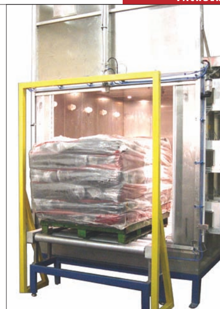
Bild 3: Mikrowellenanlage MKWT 24 für eine Palette Kautschuk (Linn High Therm GmbH)
