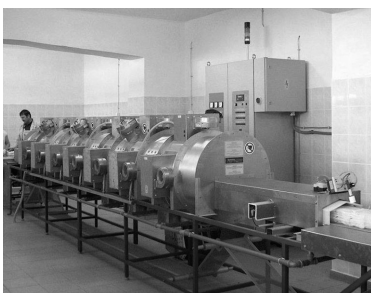
Bild 3 MDBT-Anlage in Schnellkochreis- Herstellung (installierte Mikrowellenleistung 21 kW, Durchsatz ca. 300 kg/h)
