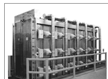
Bild 7 Prinzipielle Skizze einer Multi-Mode-Batchanlage (l.) und Mikrowellen-Kammer-Trockner MKT-30 (r.)
