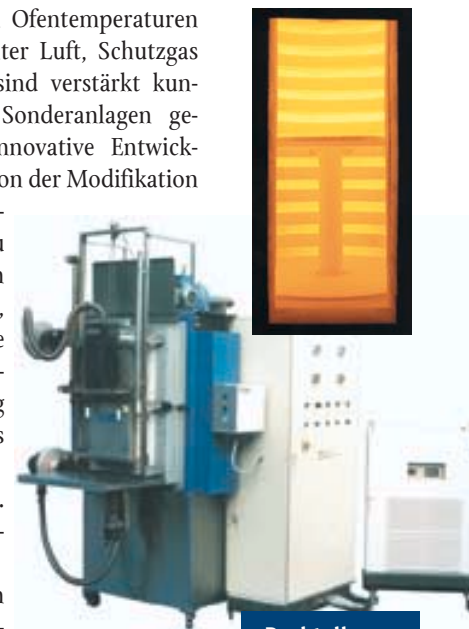
Drehteller-Kammerofen zum Vorwärmen von Schmiedeteilen
