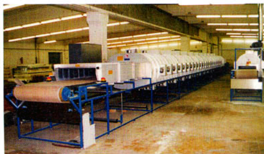
Bild 2 MDBT 70+24 für die Trocknung von Isolationsmaterialien
