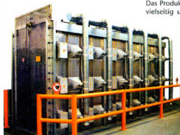
Bild 3 MKT 30 für die Trocknung von Schleifscheiben
