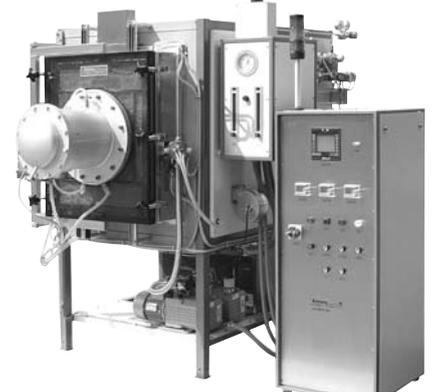
**Schutzgaskammeröfen mit Umluft bis 900 °C, 500 l**
