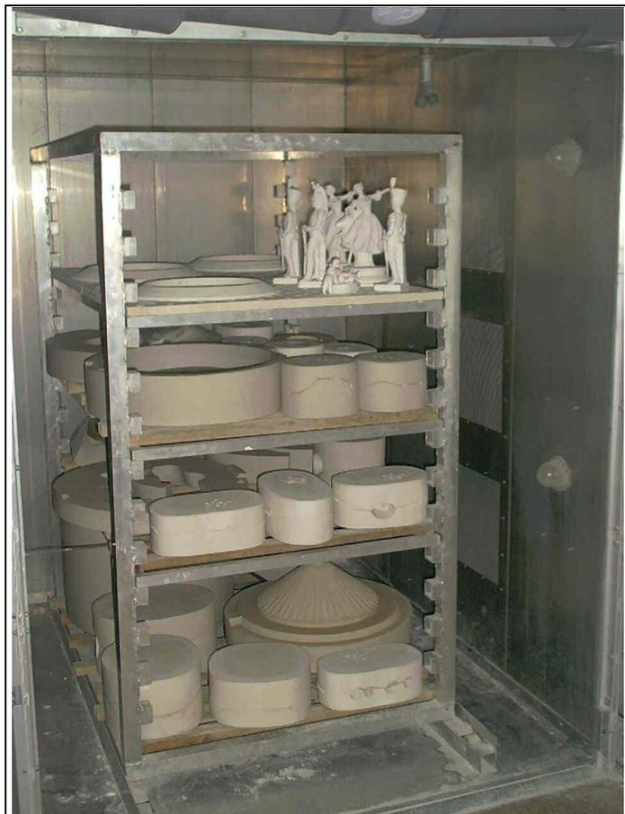
(Bild 3, Mikrowellen Kammer Trockner für Porzellanfiguren und Gipsformen)
