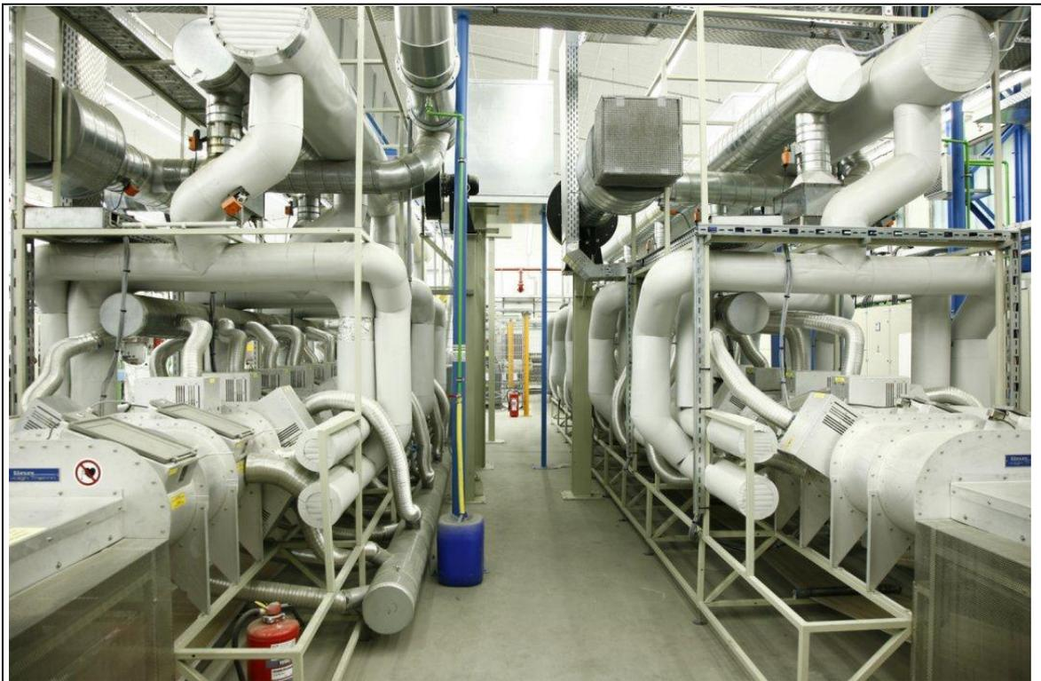
(Bild 2, Mikrowellen Band Trockner für Diesel Partikel Filter)
