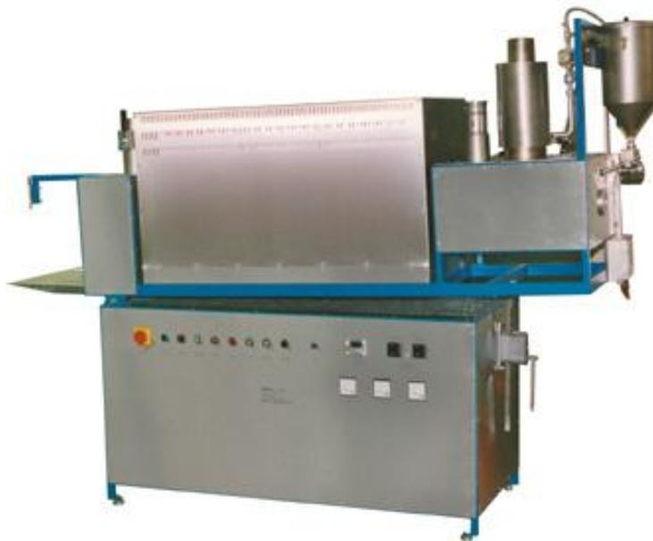
*Drehrohröfen mit Vibrationsförderer und Nachverbrennung, bis 1500 °C*
