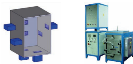
Рис. 11 Расположение магнетронов в СВЧ-камере (слева) и гибридной СВЧ-печи типа МНТ-1600 (справа)
