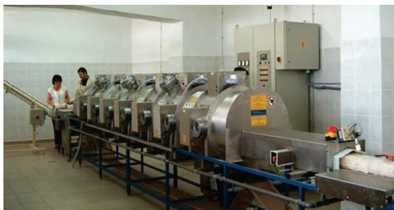
Рис. 3 Установка серии MDBT для производства риса быстрого приготовления (установленная СВЧ-мощность 21 кВт, производительность ок. 300 кг/ч)
