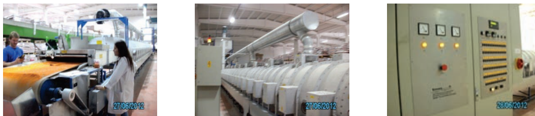
Рис. 4 Конвейерная СВЧ-печь серии MDBT 70+24/1040/210/16300 фирмы LINN HIGH THERM на производстве (установленная СВЧ-мощность 70 кВт, мощность нагретого воздуха 24 кВт, производительность ок. 2 000 – 3 000 кг/ч)
