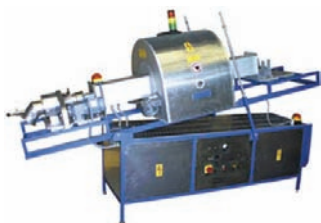
Рис. 10 Вращающаяся трубчатая СВЧ-сушилка типа MDRT (СВЧ-мощность 2,7 кВт или 5,4 кВт)
