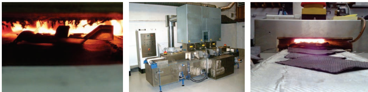
Рис. 12 Вторичное использование углеродных волокон (слева и справа) и гибридных конвейерных СВЧ-печей (середина)
