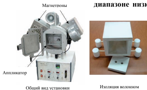
Рис. 8 Лабораторная СВЧ-печь серии МКЕ-1,6
