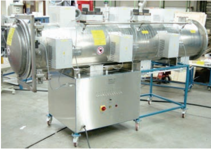
Bild 5 Камерная СВЧ-сушилка серии МКСТ-9,6 200/2500
