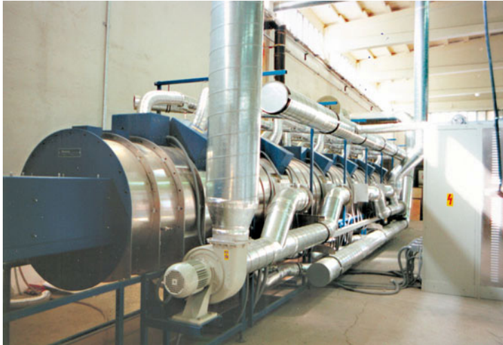
Bild 5: Mikrowellen-Banddurchlauf-Ofen für Korken, MDBT 60 kW / 15 m
