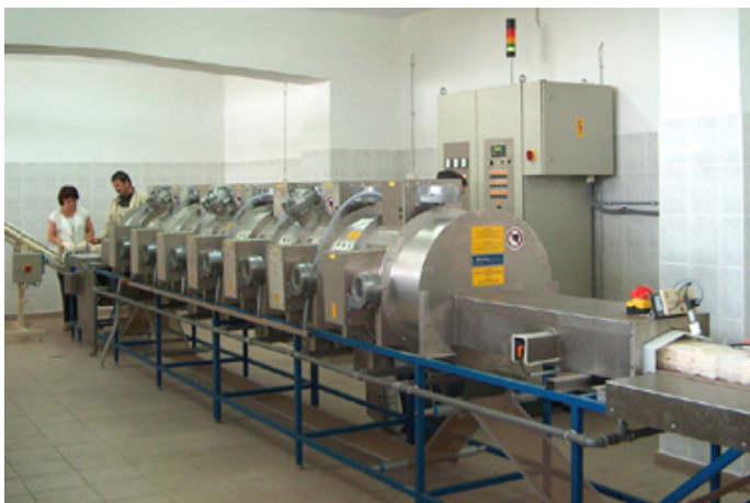
Bild 2: Mikrowellen-Durchlauf-Band-Ofen für Reis, MDBT 21 (Linn High Therm GmbH)
