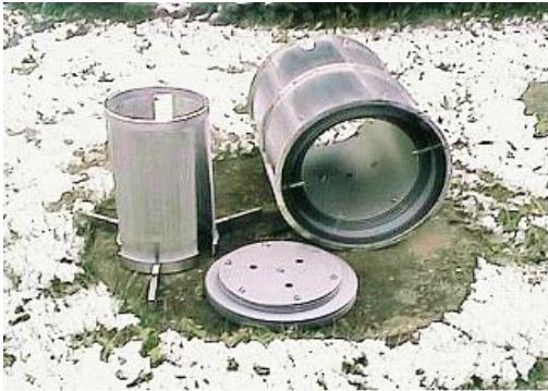
Picture 8 Wolfram – Maschenheizer T_{max} 2300 °C mit Strahlungsschirmen tungsten – mesh heater with radiation screens for T_{max} 2300 °C.
