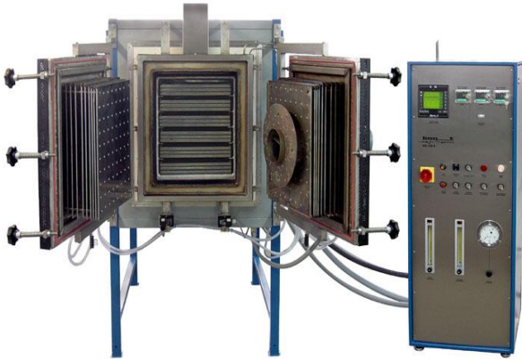
Schutzgasofen KS- S 160 mit Hordengestell und Doppeltür für Umluftbetrieb bis 950 °C oder Hochtemperaturbetrieb bis 1200 °C.
