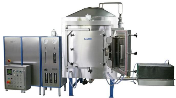
Faserisolierter Schutzgasofen KF-240S bis 1200 °C für Reinraumeinbau. Wasserstoffbetrieb und Gasrückkühlung über Gas/Wasser- Wärmetauscher für schnelle Abkühlzeiten. Reduktion und Sinterung von Edelmetallpellets.
