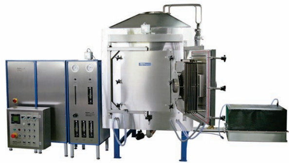
Рис. 3 Печь с защитной газовой атмосферой, изолированная волокном типа KF-240S до 1200 °С для установок высокой чистоты. Режим работы в водороде и обратное охлаждение газа за счет газового/водного теплообменника для быстрого охлаждения. Восстановление и спекание гранулятов благородного металла.
