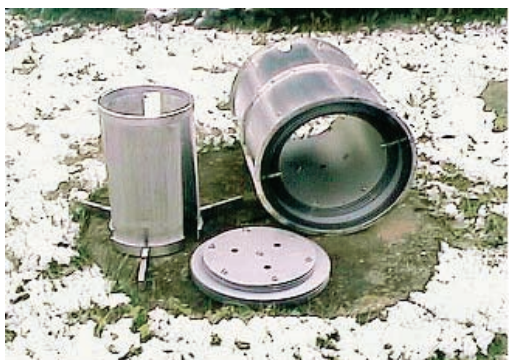
Рис. 8 Решетчатый нагреватель из вольфрама максимальная температура 2300 °С с экранами
